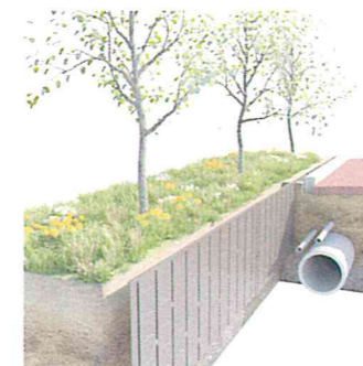
BARRIERA ANTIRADICE DA APPLICARE SULLA FACCE VERSO TERRA DEI MURI DI CONTENIMENTO
