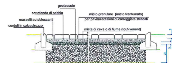
SEZIONE PAVIMENTAZIONE IN MASSELLI AUTOBLOCCANTI
